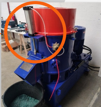
Ouverture pneumatique de la trémie de vidage
