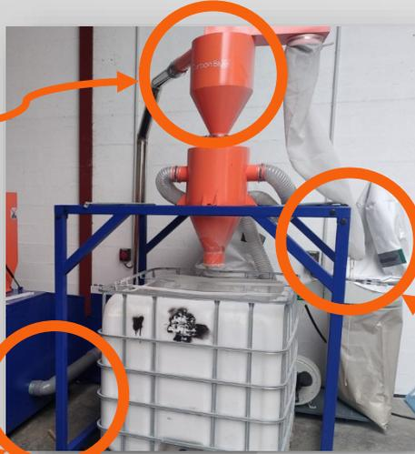
**Branchement direct en sortie de broyeur**
